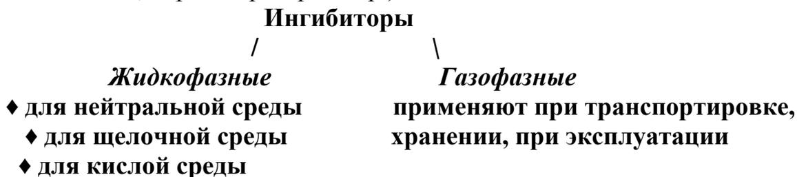
**Ингибиторы для нейтральных растворов** - неорганические вещества анионного типа (*нитриты, хроматы* и т.д.). Действие - окисление поверхности М или образованием пленки трудно растворимого соединения с М. Тормозят анодную реакцию, смещая потенциал в положительную сторону.
